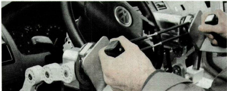
Das Lenksystem der Firma Joysteer ermöglicht es behinderten Menschen, ihr Auto selbständig zu lenken.
